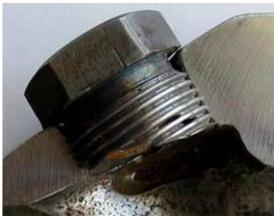
Рисунок 6 – Одностороннє розмивання конічної різьби
