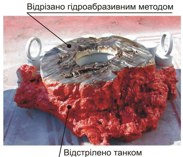
Рисунок 20 – Порівняння двох методів відрізання трубної головки 180×700-280×700 “CAMERON”
