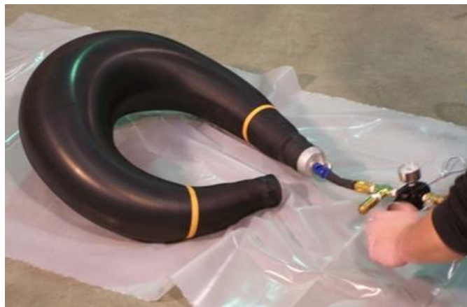
Рисунок 11 – Пакер для відводів трубопроводів Джерело: (Pipe Patch now offers Elbow Repairs, 2023)
