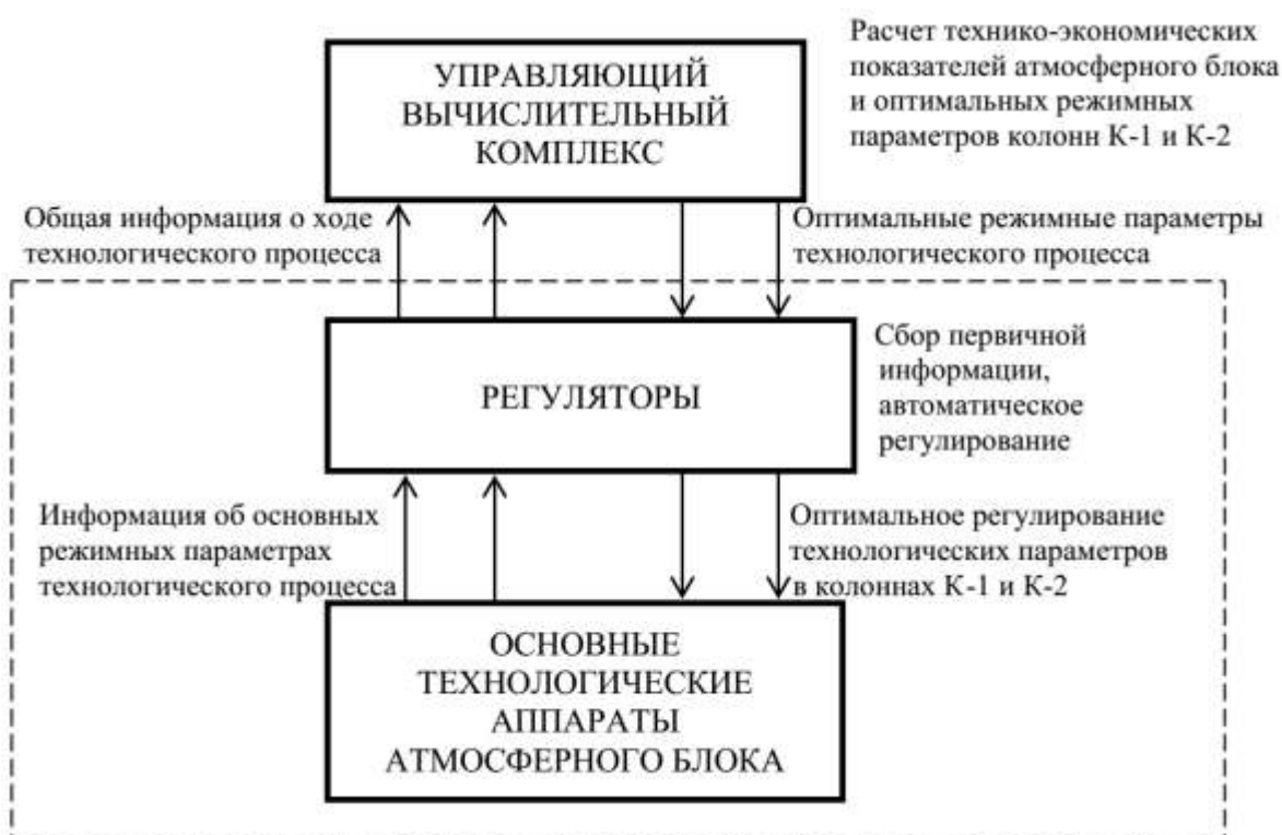
Рисунок 1 – Функциональная структура системы управления атмосферным блоком
