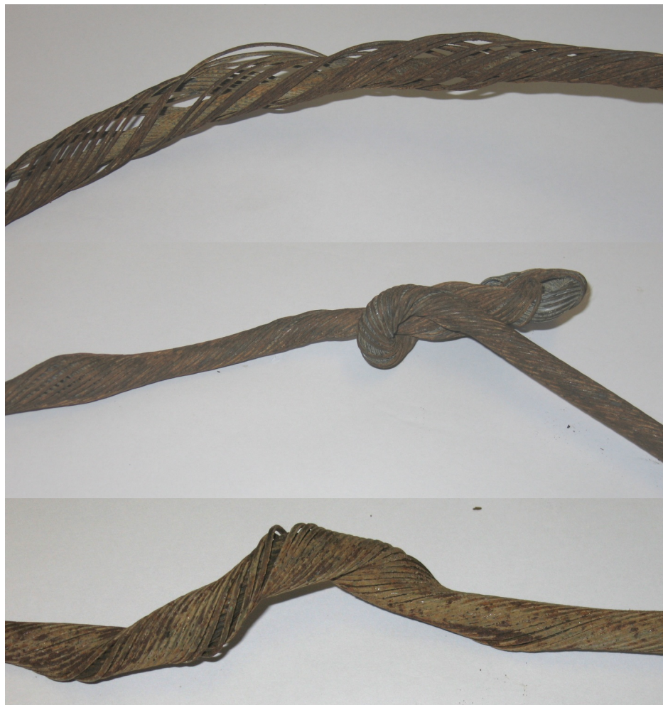
Рисунок 1 – Приклади дефектів кабелю
