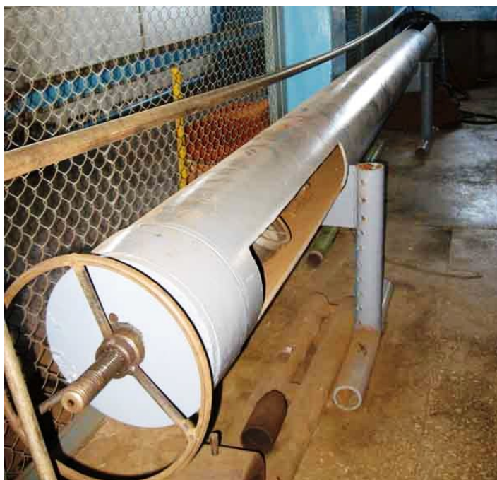
Рисунок 4 – Загальний вигляд випробної машини для дослідження міцності кабеля
