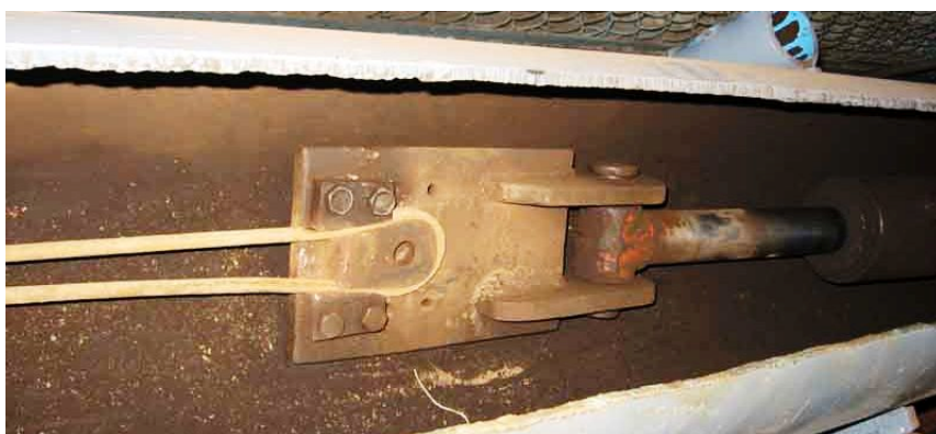
Рисунок 4 – Загальний вигляд випробної машини для дослідження міцності кабеля
