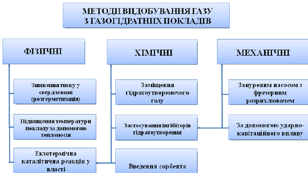
Рисунок 5 – Схема класифікації методів видобування газу з газогідратних покладів
