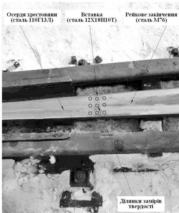
Рисунок 12 – Ділянки замірів твердості за Брінелем на поверхнях кочення елементів хрестовини
