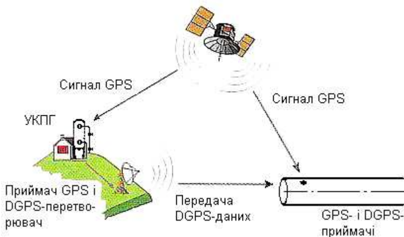
Рисунок 2 – Метод диференційованої корекції DGPS
