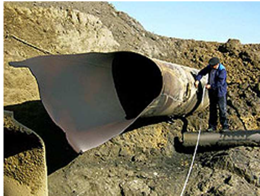
Рисунок 1 – Наслідки аварії на газопроводі, спричинені витоками газу
