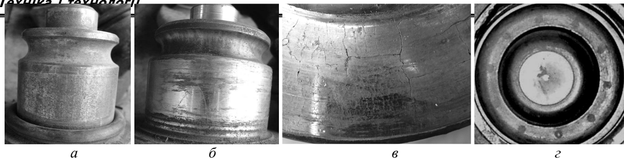
а – загальний знос опори і підтинги на біговій доріжці замкового кулькового підшипника кочення ; б – загальний знос опори та тріщини на наплавленій поверхні великого підшипника ковзання; в – тріщини і дрібне викривування наплавленого шару упорного торця лапи; г – утворення на упорному торці шарошки притертої канавки, що відповідає поверхні торця лапи
