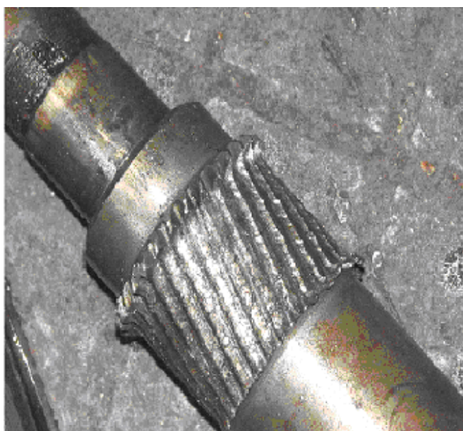
Рисунок 2 — Деформація зубів зубчатих валів
