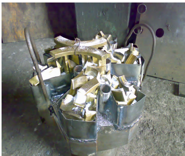
Рисунок 10 – Фрезер ФЗ-308 з робочою зоною, повністю спорядженою під паяння (армування)
