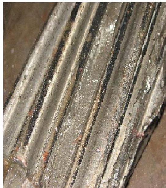
Рисунок 1 — Спрацювання зубчатих пар внаслідок викришування (а) чи виламування зубів (б)
