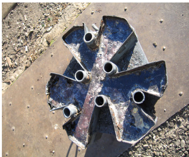
Рисунок 11 – Фрезер вибійний ФЗ-308 після операції пічного армування
