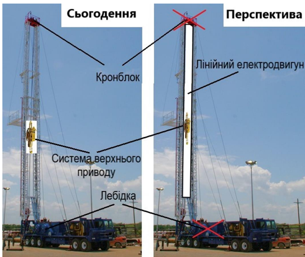
Рисунок 7 – Зміна структури побудови технічної системи верхнього приводу
