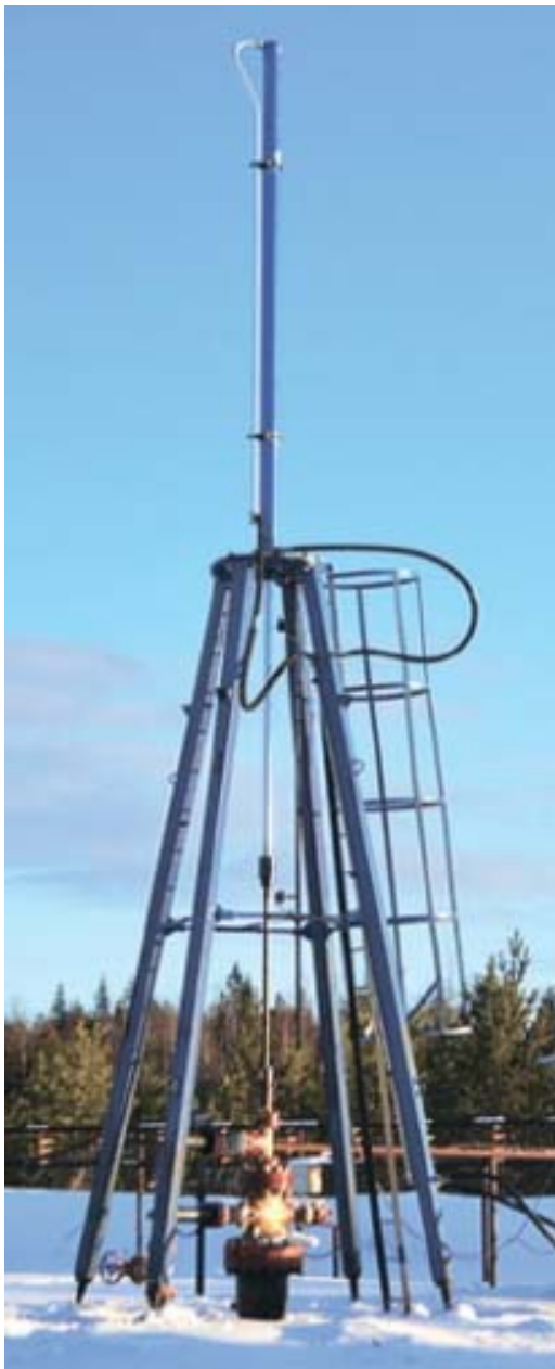
Рисунок 2 – Гідравлічний привод «Гейзер»
