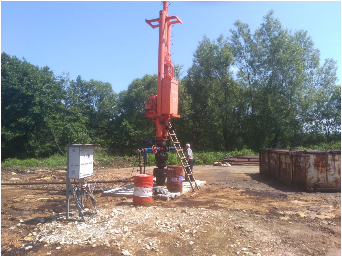
Рисунок 5 – Випробування гідропривода ПШН-80-2,5 на свердловині № 64-Долина
