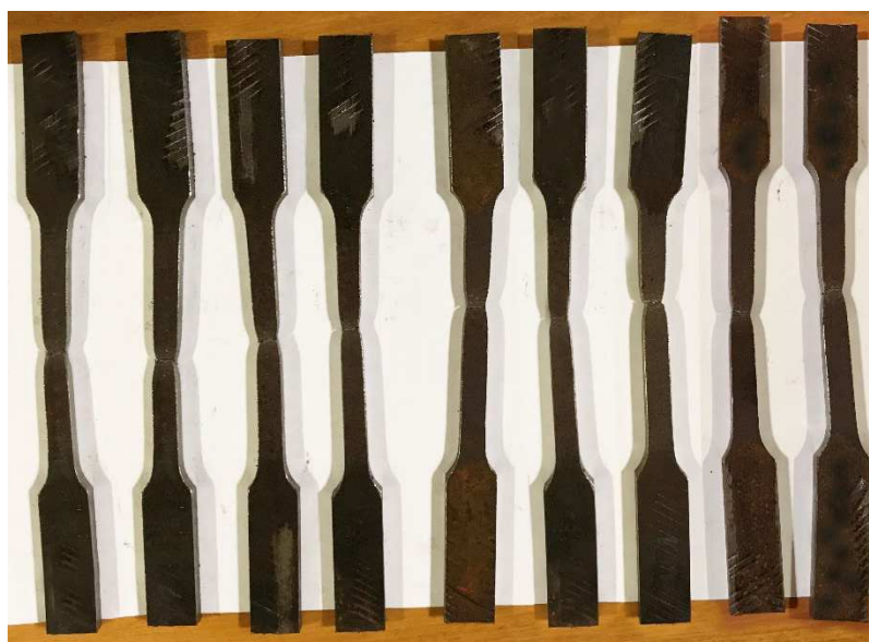
Рисунок 14 – Стандартні плоскі зразки після випробування на розтяг
