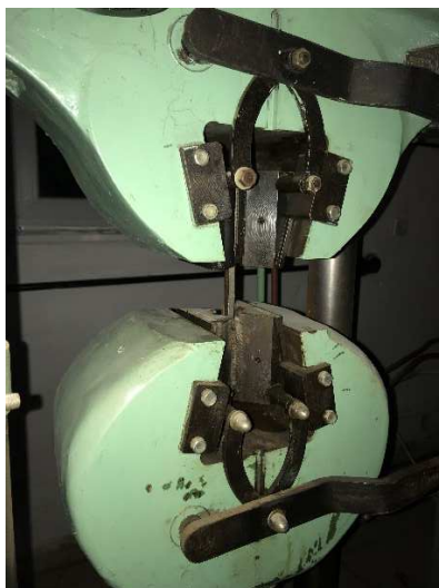
Рисунок 13 – Стандартний плоский зразок, виготовлений з НКТ, під час випробування на розтяг
