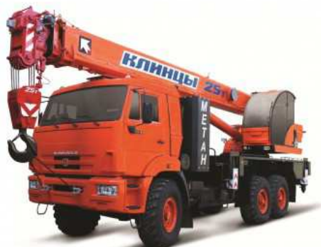
Рисунок 6 – Автокран моделі КС-55713-5К-1 з двигуном на стисненому метані
