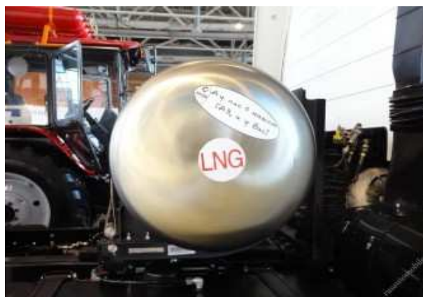
Рисунок 5 – Газобалонна система автомобіля МАЗ-536 на зрідженому метані
