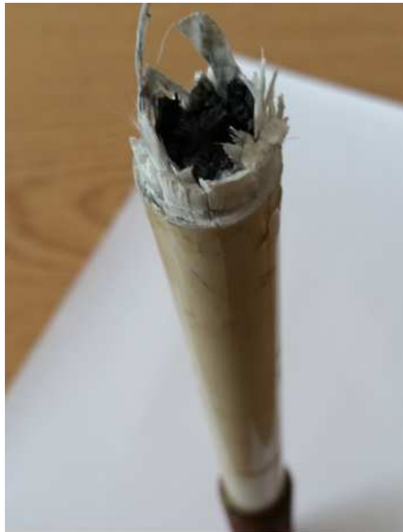
Рисунок 9 – Злам гібридної насосної штанги
