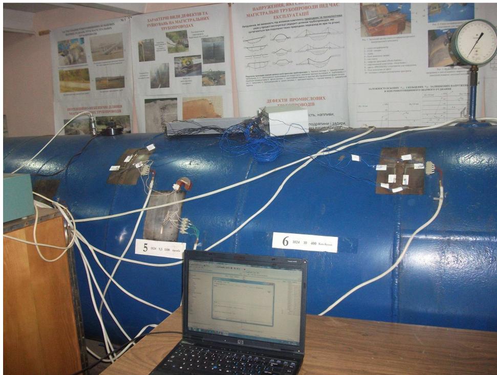
Рисунок 2 – Дослідно-вимірювальний комплекс для експериментального визначення характеристик напружено-деформованого стану в зоні основного металу і кільцевих зварних з'єднань труб МТ
