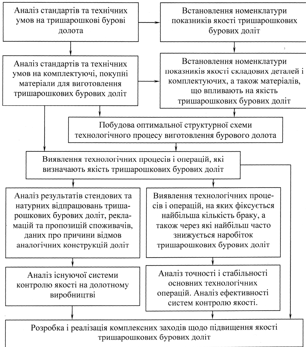
Рисунок 4 – Схема виявлення параметрів елементів технологічної системи, які визначають якісні показники тришарошкових бурових доліт
