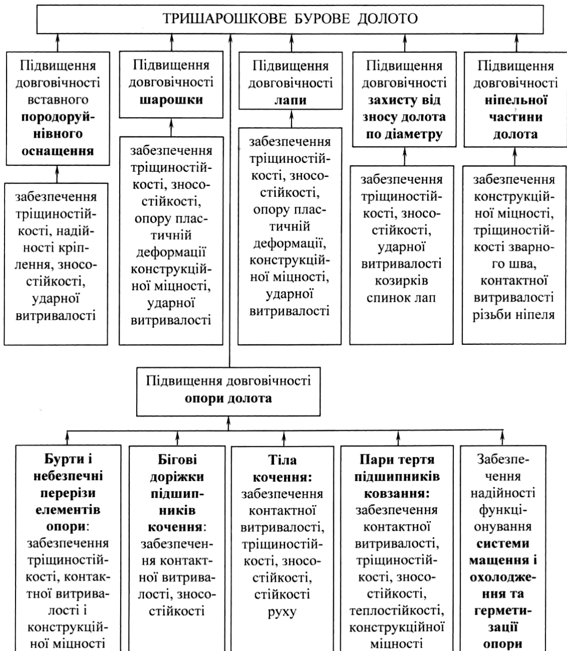
Рисунок 2 – Структура реалізації комплексного підходу у підвищенні довговічності тришарошкових бурових доліт призначених для буріння особливо міцних гірських порід
