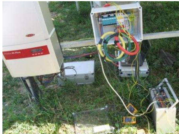
Рисунок 4 – Приєднання ІВАПК до вихідних затискачів інвертора Fronius
