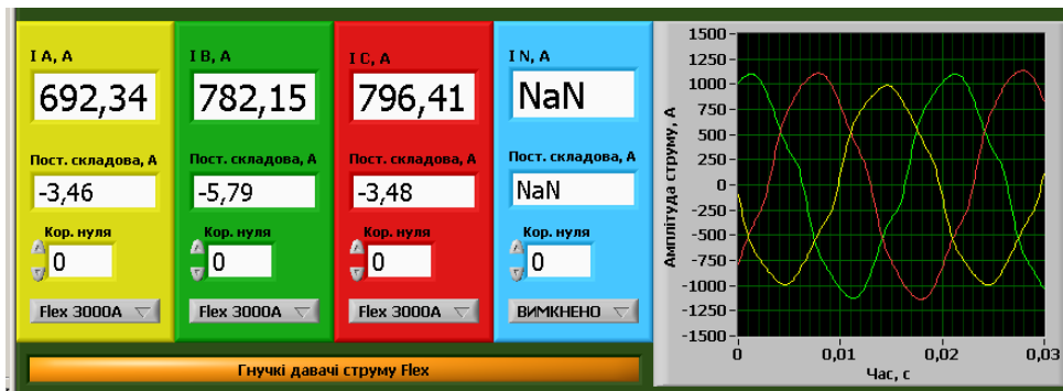
Рисунок 11 – Панель реєстратора з миттєвими значеннями струмів в трьох фазах під час вимірювання параметрів сонячної електроенергії
