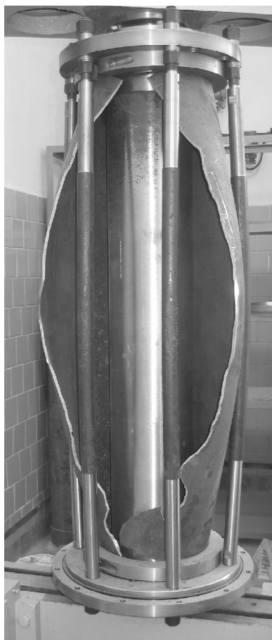
Рисунок 12 – Приклад крихкого руйнування труби
