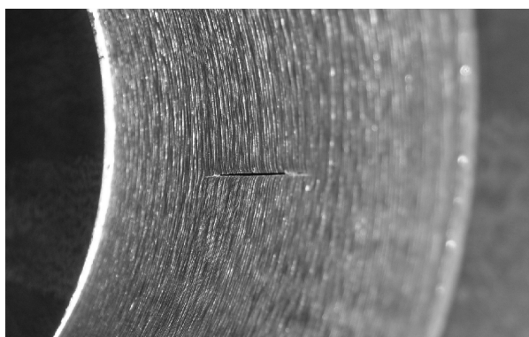
Рисунок 12 – Приклад крихкого руйнування труби
