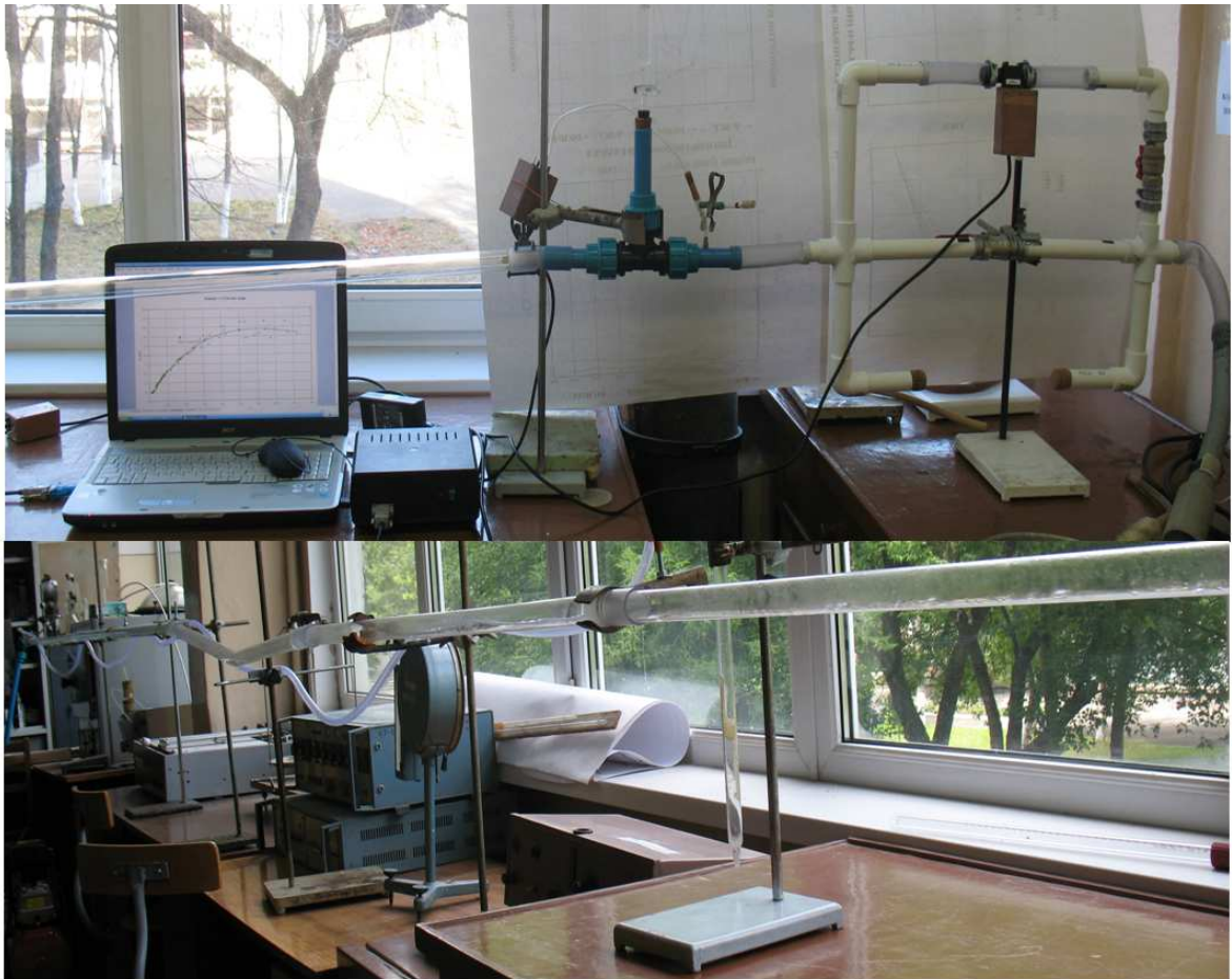
Рисунок 2 – Загальний вигляд експериментальної установки для дослідження процесу руху газорідного потоку в рельєфному трубопроводі
