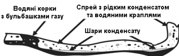
Рисунок 1 – Рух рідких корків та багатофазного потоку флюїду в трубопроводі свердловини
