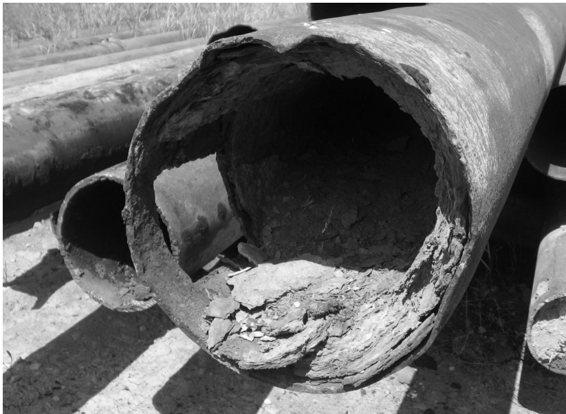
Рисунок 2 – Труба з мінеральними відкладеннями, що містять NORM
