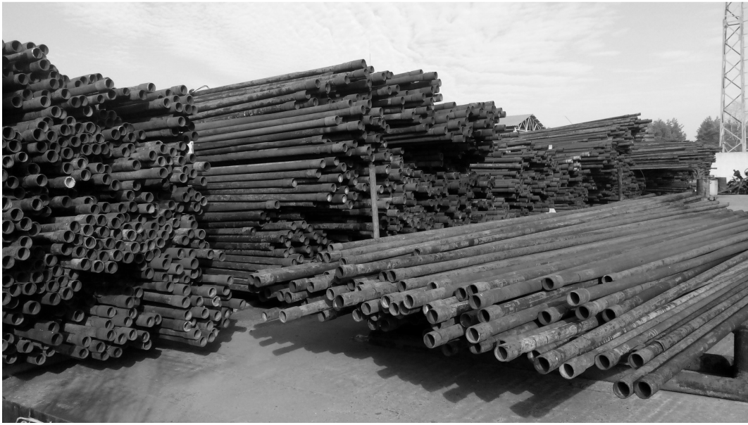
Рисунок 1 – Майданчик НГВУ «Охтирканафтогаз» для тимчасового зберігання НКТ, забрудненого природними радіонуклідами
