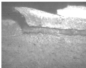
Рисунок 7 – Типове відшарування фрагментів цементованого шару (×500)
