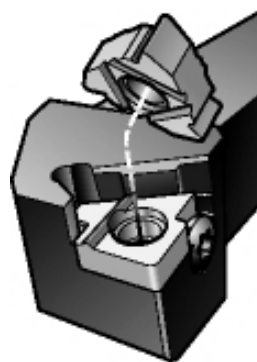
Рисунок 6 – Встановлення робочої різальної пластини на підкладну пластину
