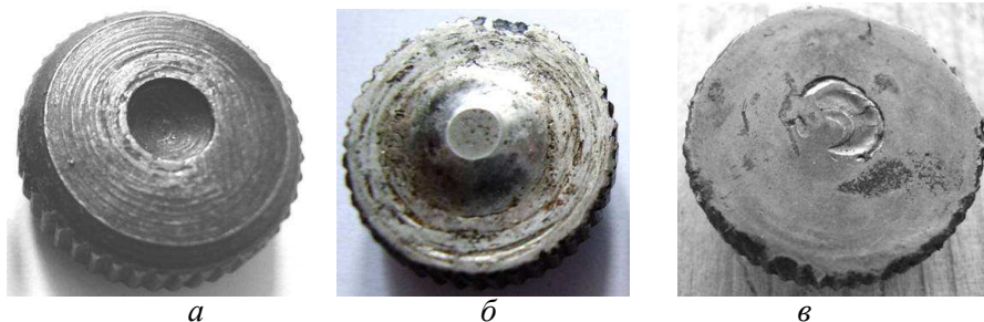
а – перед пресуванням (після пресування шліфується і полірується), б, в – після відпрацювання і зносу опори
