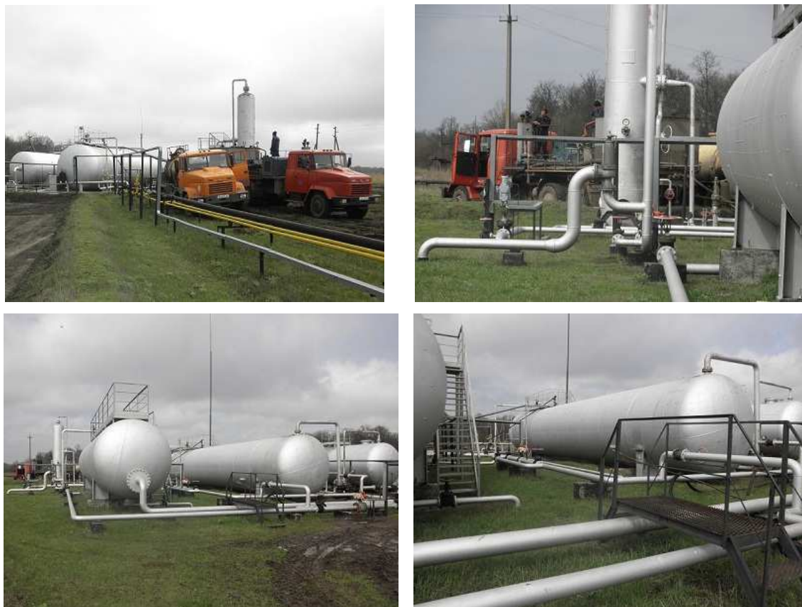
Рисунок 5 – Проведення гідравлічного випробування смності ПЕ 200-16 ГС
