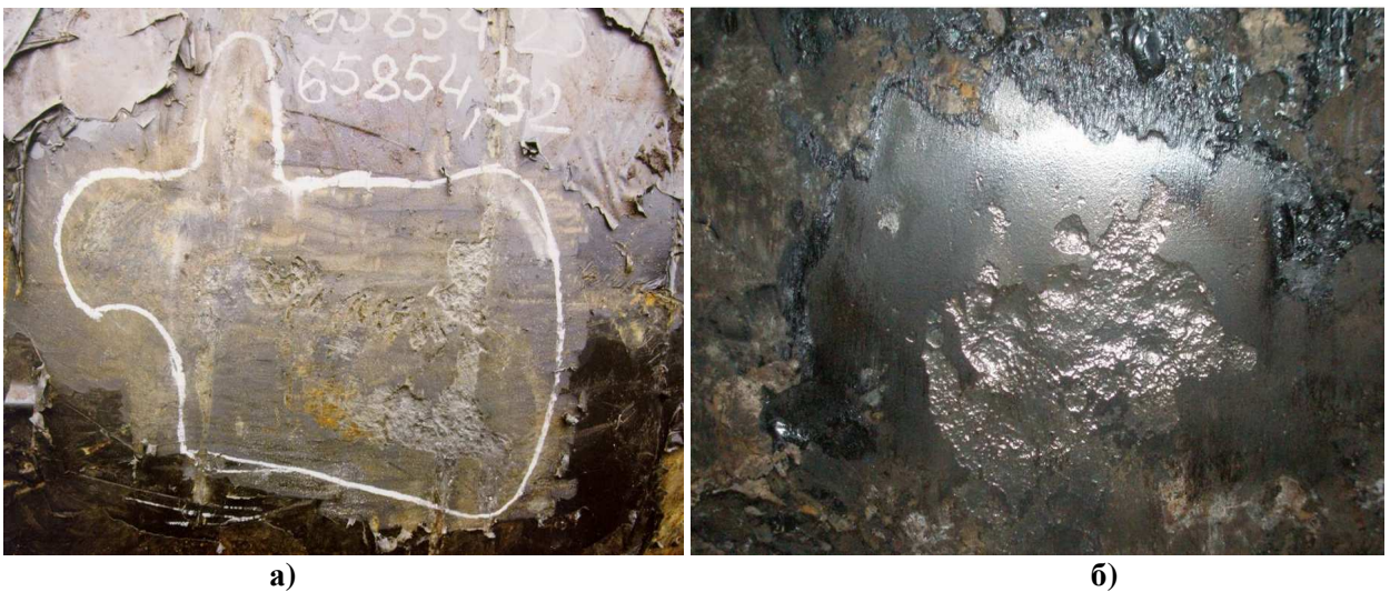
Рисунок 4 – Приклади корозійного (а) та електрокорозійного (б) пошкоджень основного металу
