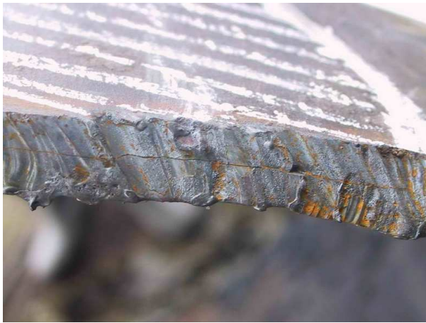
Рисунок 5 – Приклад розшарування основного металу
