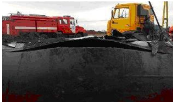
Рисунок 1 – Поздовжній розрив нафтопроводу "Дружба-1" діаметром 530 мм [5]
