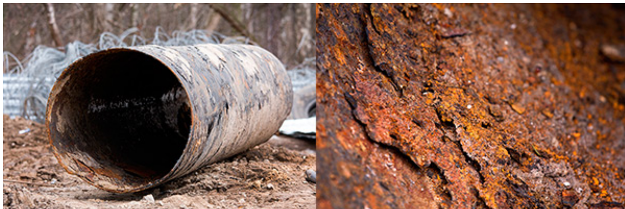
Рисунок 1 – Наслідки корозії промислових трубопроводів
