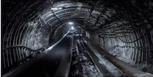
Рисунок 1 – Положення траси шахтного газопроводу у просторі гірничої виробки
