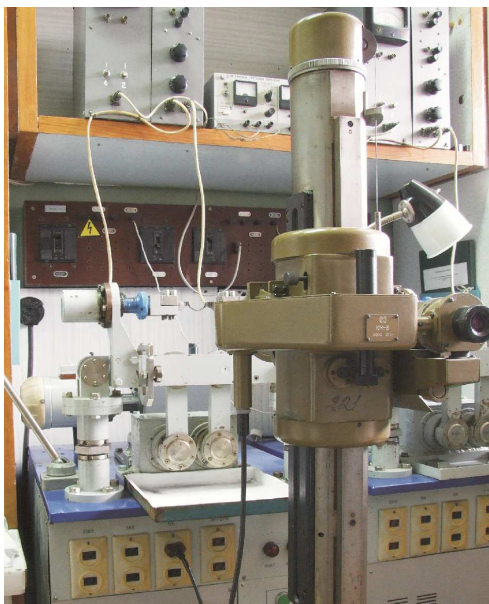
Рисунок 3 – Загальний вигляд установки для випробування балкових зразків за циклічного навантаження в умовах чистого згину
