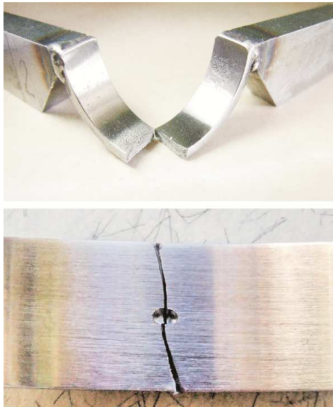
Рисунок 5 – Загальний вигляд зразка зі сталі А606 тип 4 після випробувань
