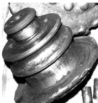
Рисунок 3 – Цапфа лапи зі сталі 14ХГНЗМА-Ш від відпрацьованої партії доліт 250,8 ОК-ПГВ Д150 (долото пробурило 211м у породі міцністю f = 18 )
