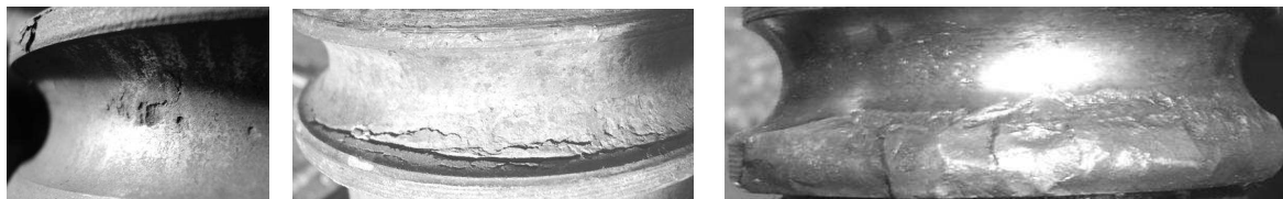
Рисунок 4 – Характер руйнування при недостатній твердості і міцності поверхневих шарів бігової доріжки цапфи лапи (цементований шар містить карбіди 1-3 балу)
