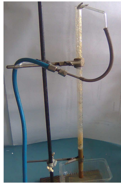
Рисунок 2 – Модель процесу видалення піщаного корка
