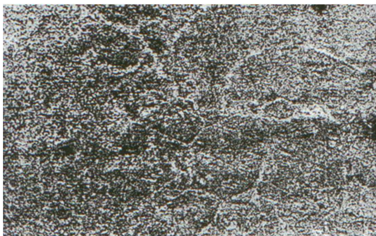
Рисунок 6 – Мікροструктура зварного з'єднання сталі 30ХГСА з вмістом бейніту і мартенситу приблизно 50%х50%
