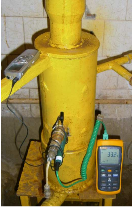
Рисунок 5 – Вимірювання процесу поширення температури та акустичних хвиль удосконаленого гідравлічного генератора імпульсно-хвильової дії за допомогою термометра FLUKE 54 П та диктофона OLYMPUS VN-480PC
