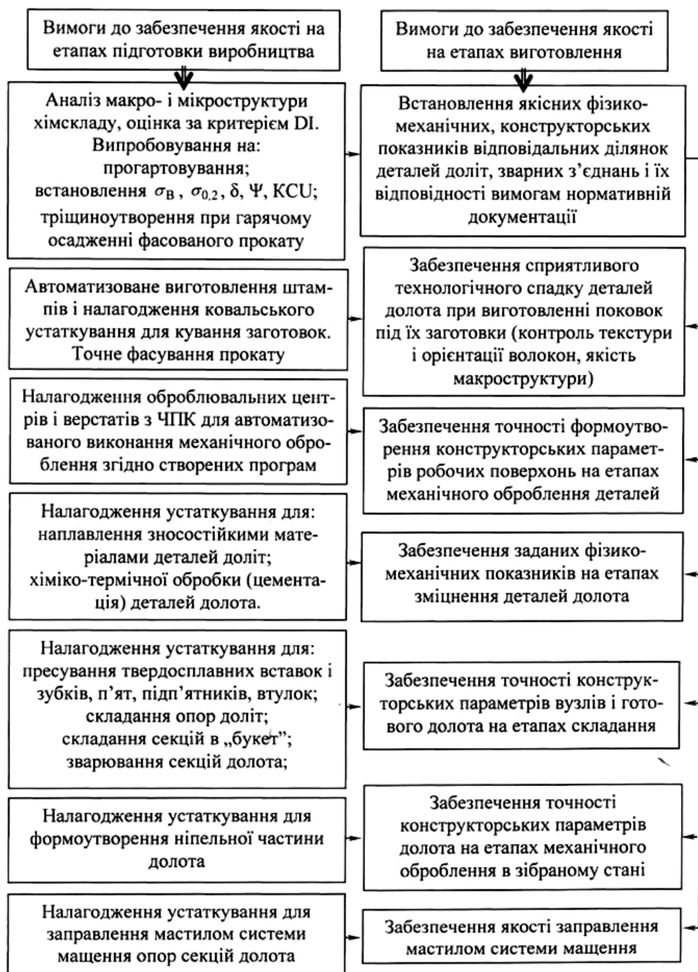
Рисунок 2 – Структура реалізації комплексного підходу у підвищенні якості тришарошкових бурових доліт на довиробничому і виробничому етапах їх життєвого циклу
