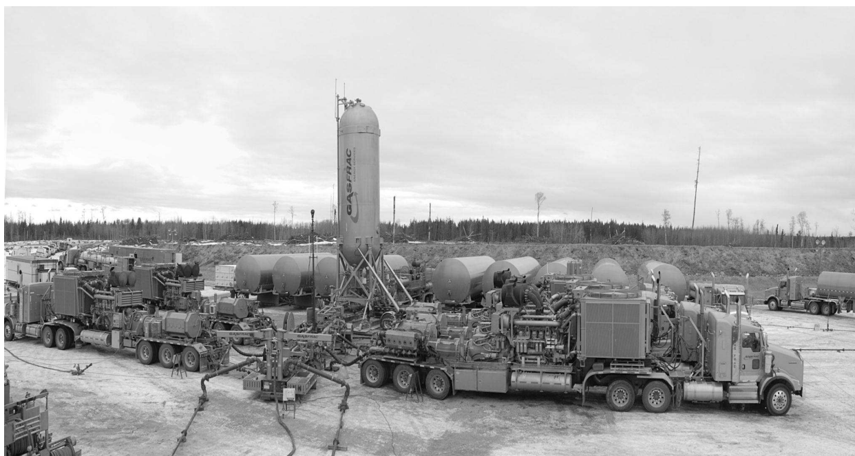
Рисунок 11 – Обв'язка гірла свердловини та розташування техніки при проведенні безводного ГРП
