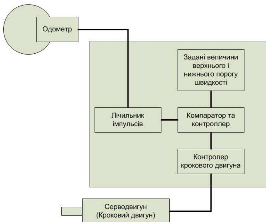
Рисунок 6 – Складові елементи системи контролю швидкості та логічні зв'язки між ними
