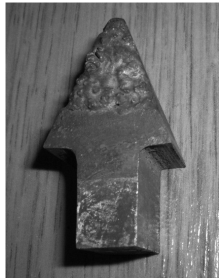
Рисунок 7 – Досліджувані зразки у вигляді фрезерованих зубків
