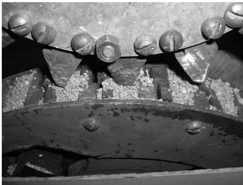
Рисунок 8 – Моделювання умов роботи елементів озброєння породоруйнівного інструменту
