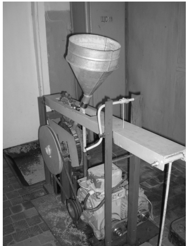
Рисунок 6 – Проведення досліджень на ударно-абразивне зношування елементів озброєння бурового інструменту
