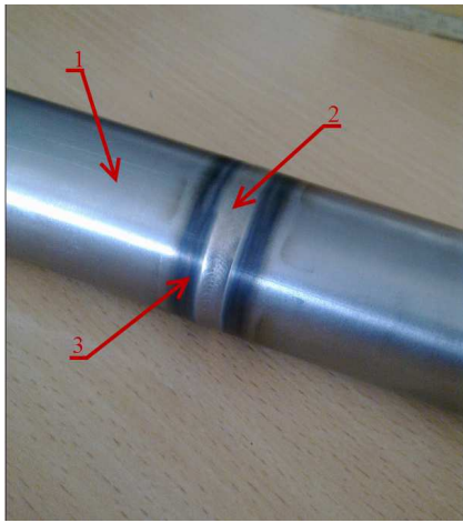
1 – основний метал; 2 – зварний шов; 3 – зона термічного впливу
