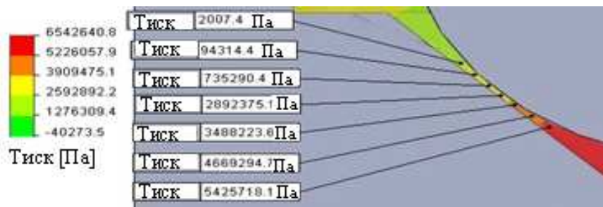
Рисунок 6 – Еюра розподілу тиску в щіліні клапана
