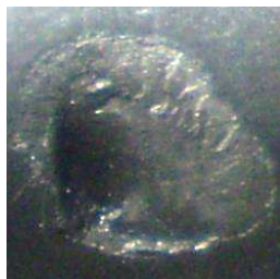
Рисунок 6 – Характерний вигляд локального втомного контактної руйнування поверхні бігової доріжки, утвореного ростом системи тріщин від підповерхневого дефекту в цементованому шарі ×10р
