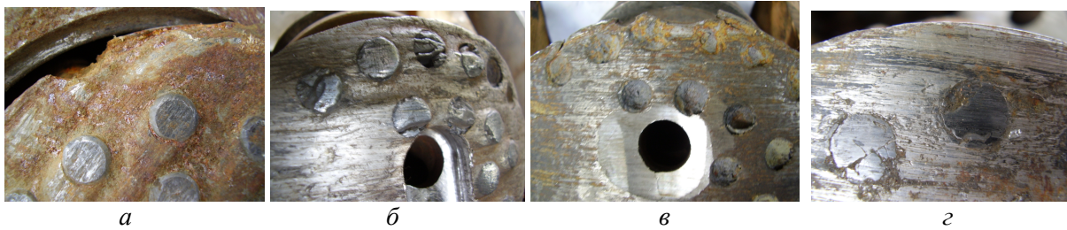
а – руйнування козирка спинки лапи у випадку зношування наплавленого шару реліто; б – розколювання твердосплавних вставок і значне зношування між твердосплавними вставками спинки та козирка; в – випадання твердосплавних вставок у результаті значного зношування спинки та козирка; з – рівномірне зношування наплавленого релітом козирка спинки і твердосплавних вставок в експериментальних долотах
