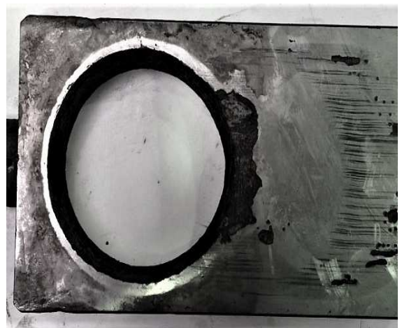
Рисунок 14 – Знос шибера у промислових умовах [5]
