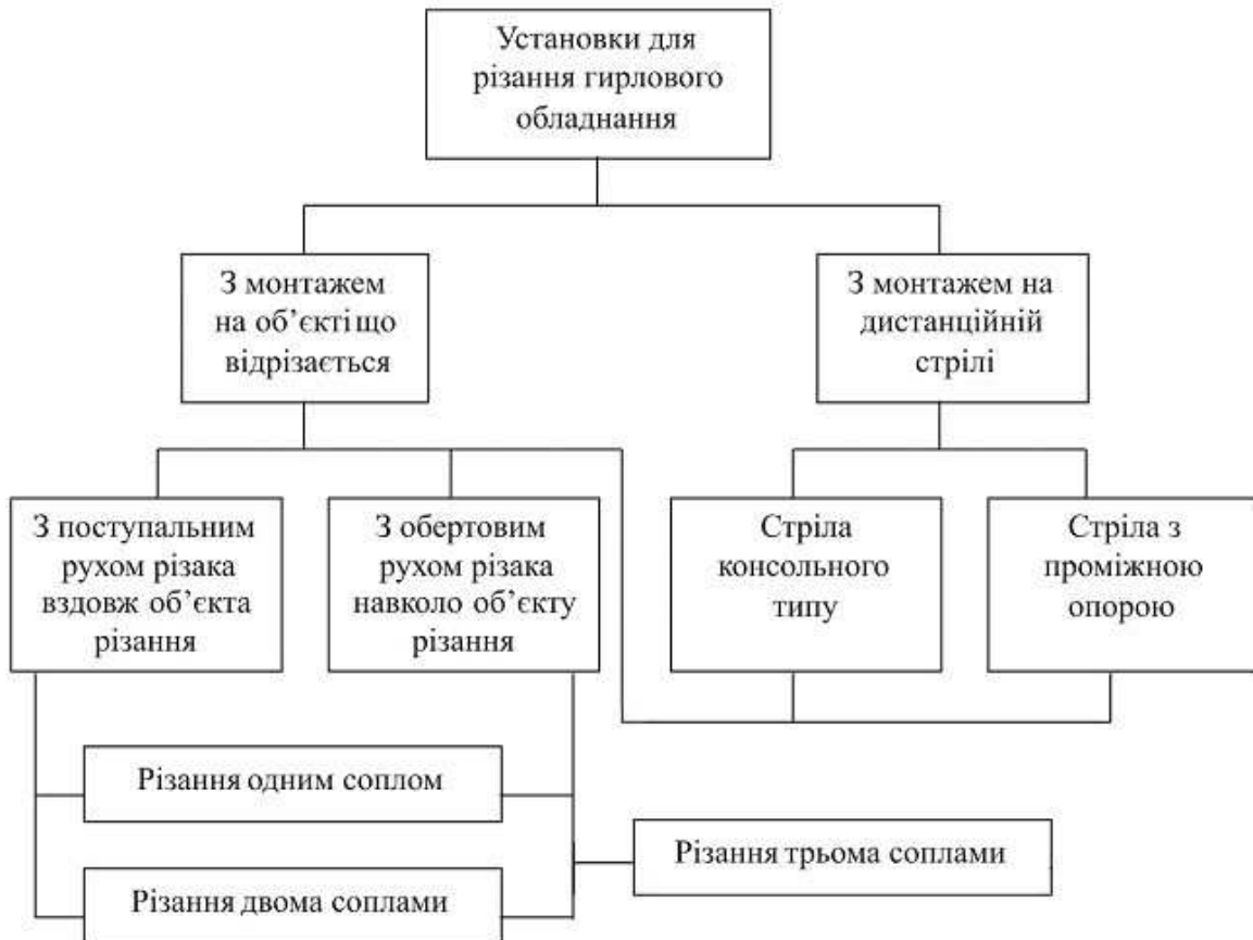
Рисунок 2 – Класифікація установок різання гирлового обладнання
