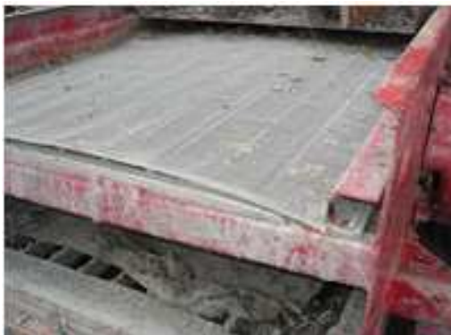
Рисунок 5 – Ситополотно випуклої форми (поверхня звичайна)
