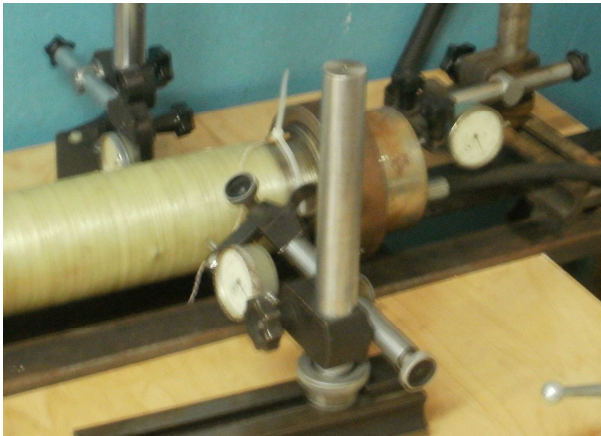
Рисунки 7 – Випробування моделі лінійної ділянки рухомого трубопроводу дією температурних навантажень
