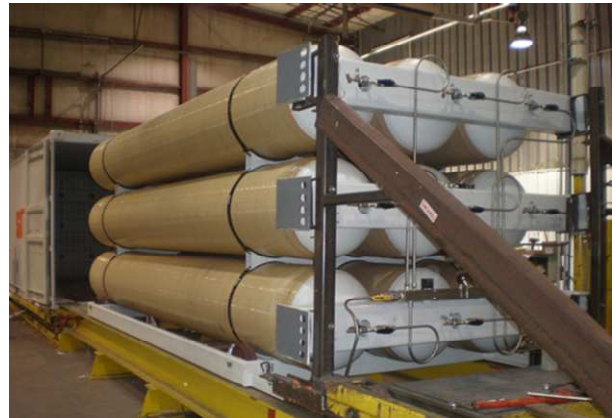
Рисунок 2 – Модуль KGTM, розроблений на базі балонів типу CNG-2
