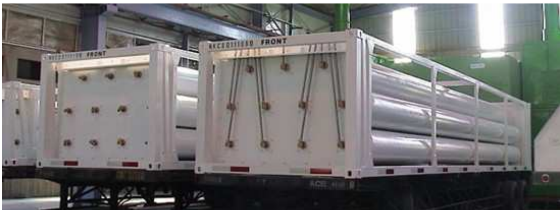
Рисунок 3 – Модулі на базі балонів типу CNG-1
