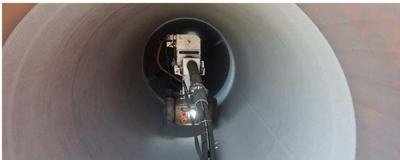
Рисунок 2 – Роботизоване абразиво-струменеве очищення внутрішньої стінки трубопроводу Джерело: (4 Key Benefits of Robotic Abrasive Blasting, 2015)
